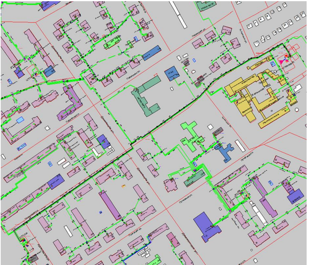
Рисунок 3.59 – Трассировка теплопровода от котельной АО «Теплоэнерго» по ул. Таллинская, д. 15В до конечного потребителя «ЦТП-204»
