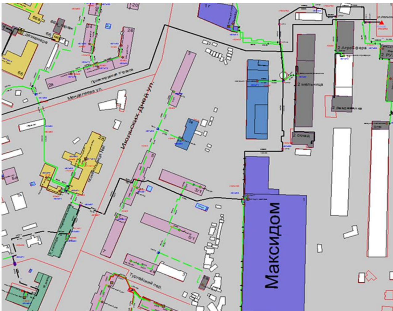
Рисунок 3.29 – Трассировка теплопровода от котельной АО «Теплоэнерго» по ул. Июльских дней, д. 1 до конечного потребителя «ПТ-Июл.дней, 10 школа»
