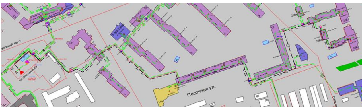
Рисунок 3.47 – Трассировка теплопровода от котельной АО «Теплоэнерго» по пр. Союзный, д. 43 до конечного потребителя «ПТ-Комин,256 э2»
