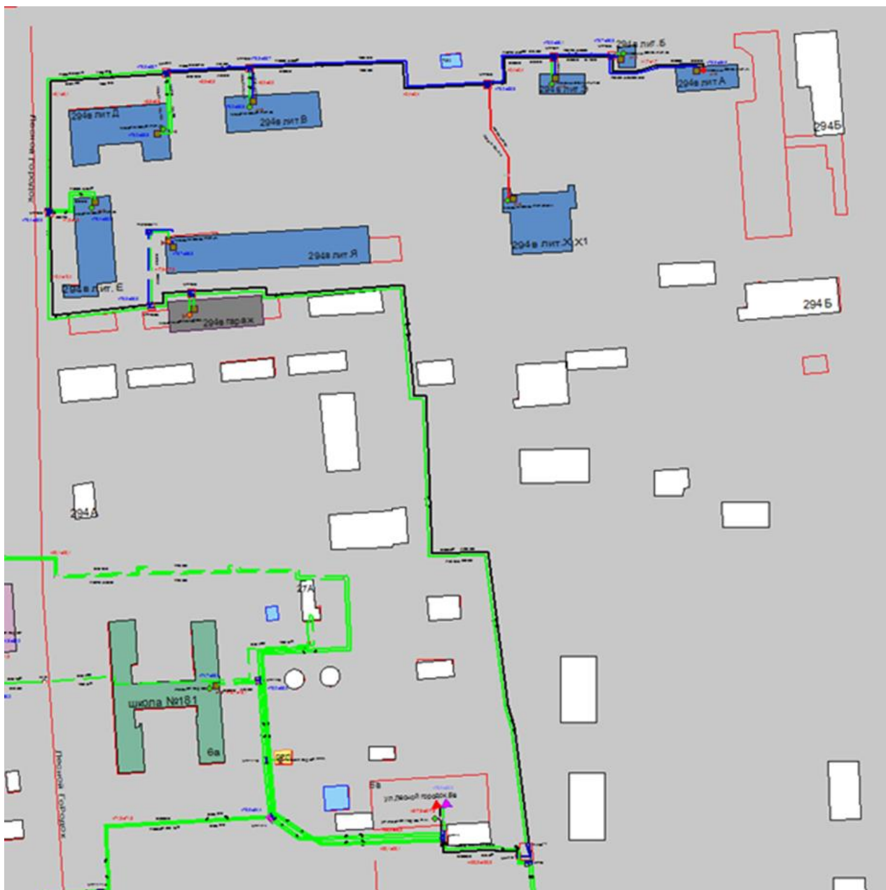
Рисунок 3.27 – Трассировка теплопровода от котельной АО «Теплоэнерго» по ул. Лесной Городок, д. 6В до конечного потребителя «ПТ-Моск.ш, 294в лит.Б»
