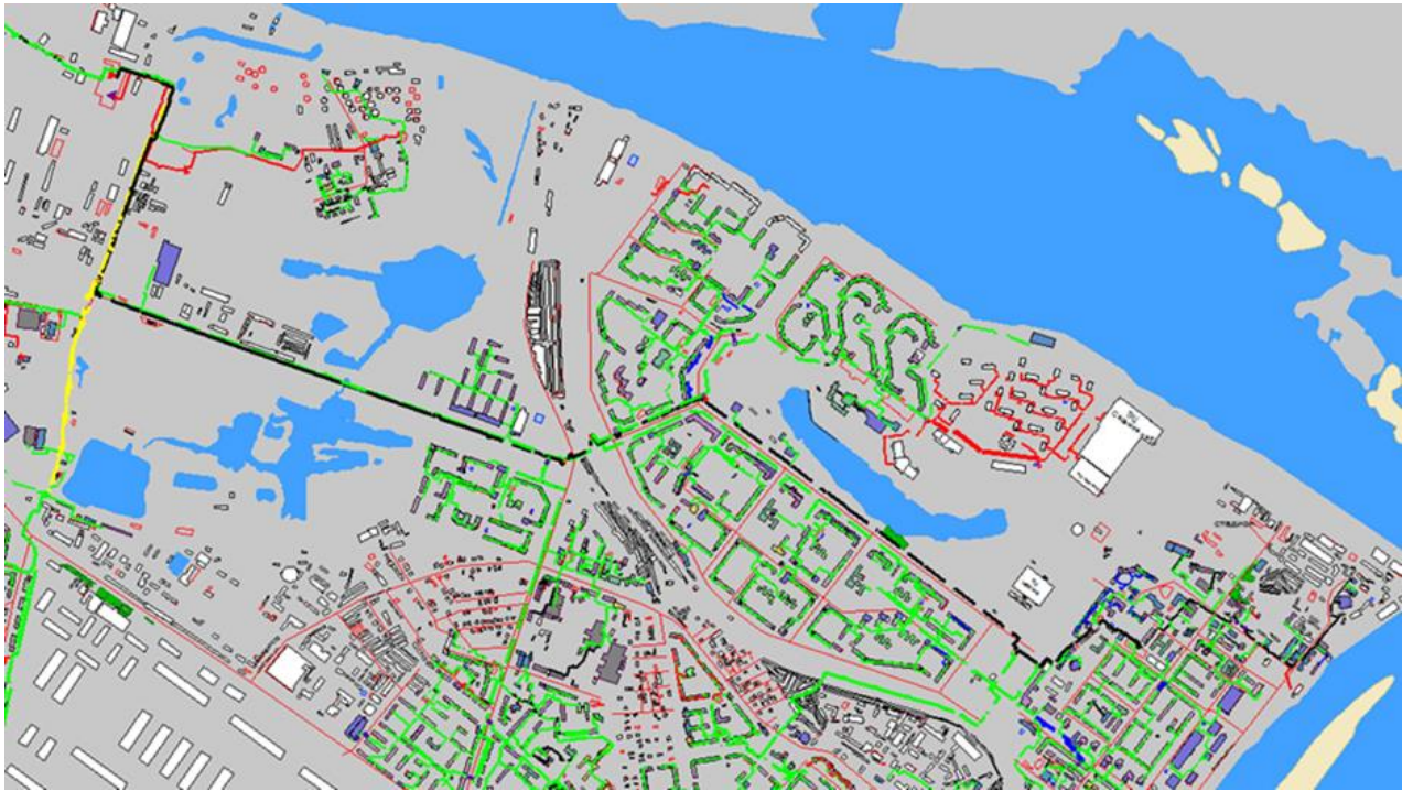
Рисунок 3.5 – Трассировка теплопровода от Сормовской ТЭЦ до конечного потребителя «ПТ-Стрел,19»
