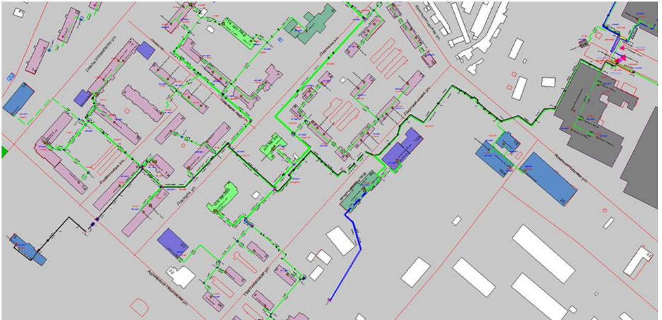
Рисунок 3.23 – Трассировка теплопровода от котельной АО «Теплоэнерго» по ул. Памирская, д. 11 до конечного потребителя «ПТ-Нахимова,3»
